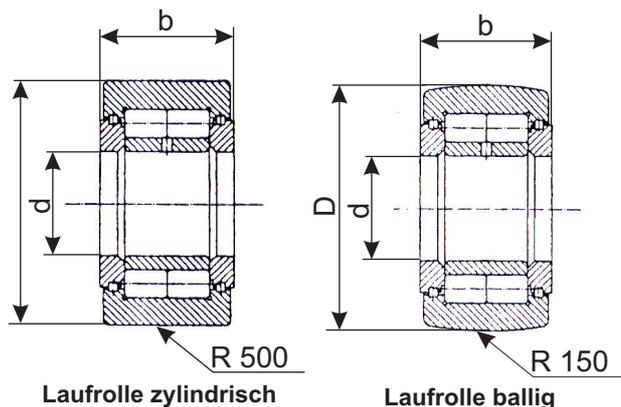
Unsere Lünetten-Laufrollen sind Hochpräzise gefertigt in Genauigkeitsklasse P05 und wir garantieren mit unserer präzisen Abdichtung, durch Metalllamellen höchste Präzision und lange Lebensdauer.
